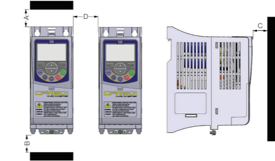
(c) Espaços livres mínimos para ventilação
