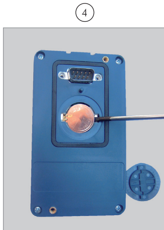
Die Batterie mit Hilfe eines Schraubendrehers auf der rechten Seite entfernen
