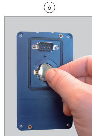
Zum Einbau der Batterie diese zunächst auf der linken Seite einlegen
