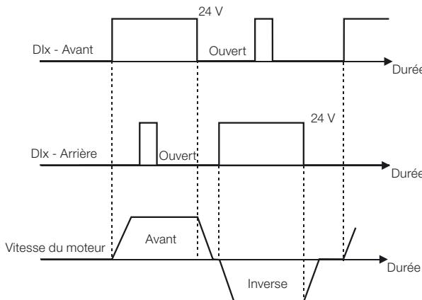
Figure 4,8 : fonctionnement de l'application Marche avant/arrière
