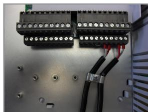
Figure 3.7 (a) et (b): Connexion du blindage
