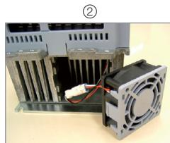
Die Lüftung entfernen
