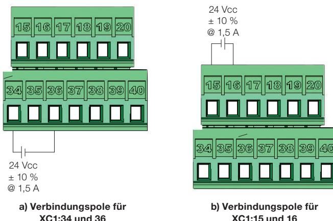
Abbildung 7.1: Externe Stromversorgungskapazität mti 24 VDC und Verbindungspolen
