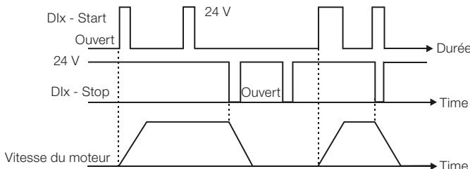
**Figure 4.7 : Fonctionnement de l'application Marche/Arrêt sur 3 fils**
