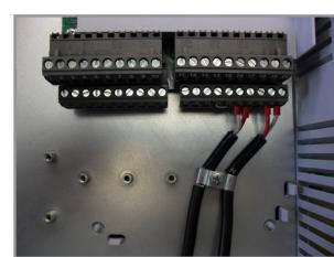
Afbeelding 3.7: (a) en (b) Aansluiting van de afscherming
