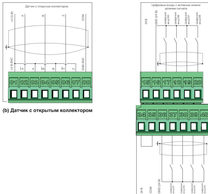
**Рис. 3.5.** Зажимы подключения XC1 от (а) до (с)
