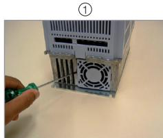
**Openen van het slot van het ventilatordeksel**
