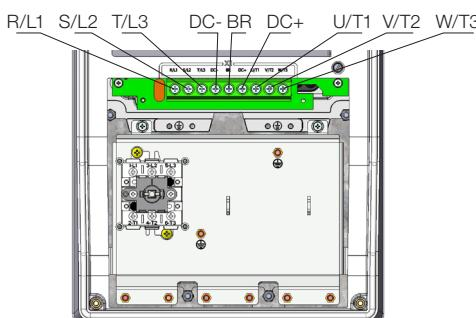
**R/L1, S/L2, T/L3:** Wechselstromversorgung
