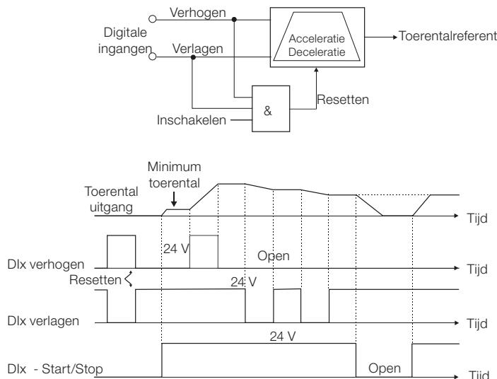
**Afbeelding 4.5:** Werking van de toepassing Elektronische potentiometer (EP)
