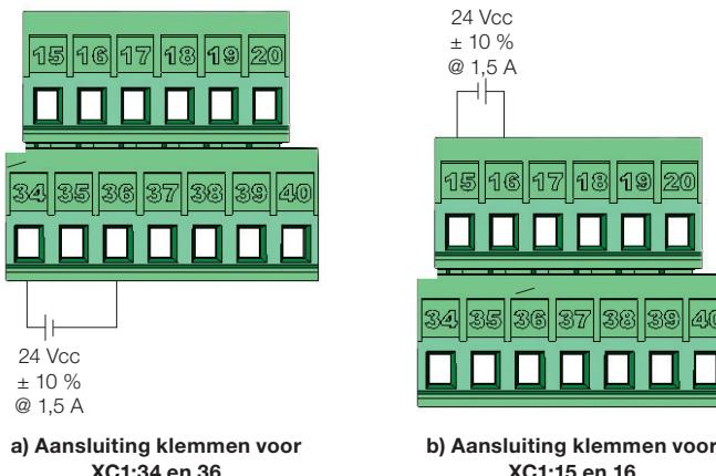
Afbeelding 7.1: Extern 24 Vdc netvoedingsvermogen en aansluitklemmen
