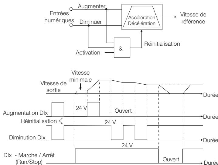
Il est nécessaire de configurer le paramètre P0221 ou P0222 avec la valeur 7 = SoftPLC pour que le potentiomètre électronique fonctionne.
