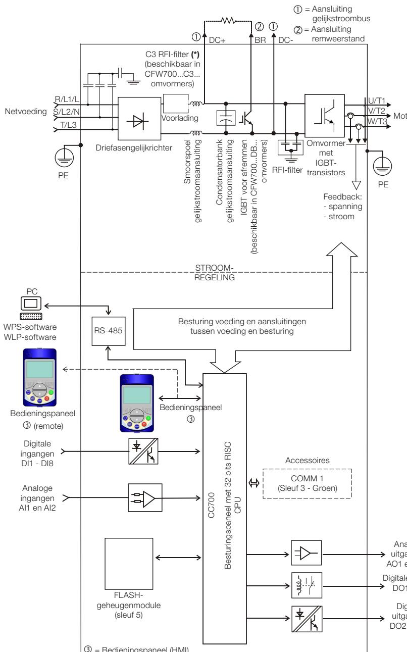
(\*) De condensator naar de aarde van het C3 RFI-filter (met dit filter kan voor modellen van bouwgroottes A worden voldaan aan de vereisten van de categorie C2) moet worden losgekoppeld voor IT-netwerken en voedingen voor geaarde driehoekschakelingen. Zie sectie 3.2.3.1 Ingangsaansluitingen.
