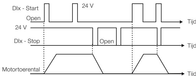
**Afbeelding 4.7:** Werking van de toepassing Start/Stop met 3 draden
