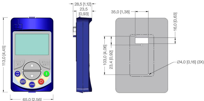
Das Zubehör für das Tastaturgehäuse kann auch zur Befestigung des HMI verwendet werden, siehe Abschnitt 7.2 Zubehör.
