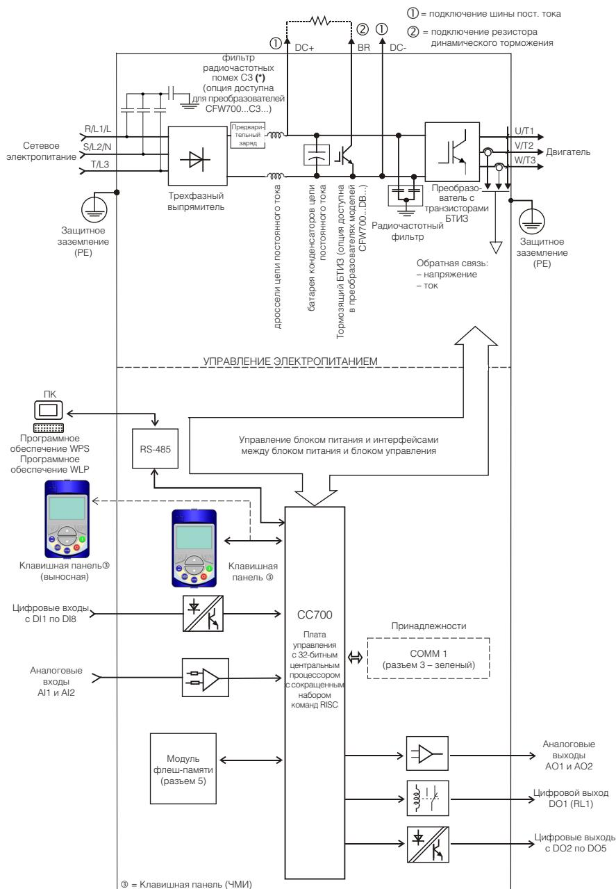
(\*) В случае использования преобразователя в сетях энергоснабжения с системой заземления IT или с подключением типа «заземленный треугольник» конденсатор, соединяющий радиочастотный фильтр С3 (использование данного фильтра позволяет преобразователям в корпусе А соответствовать требованиям категории C2) с заземлением, должен быть отключен. (3) См. разд. 3.2.3.1 Соединения на вводе.
