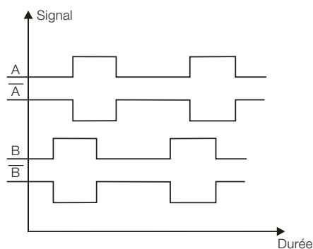
Figure 3.6 : Séquence des signaux de l'encodeur
