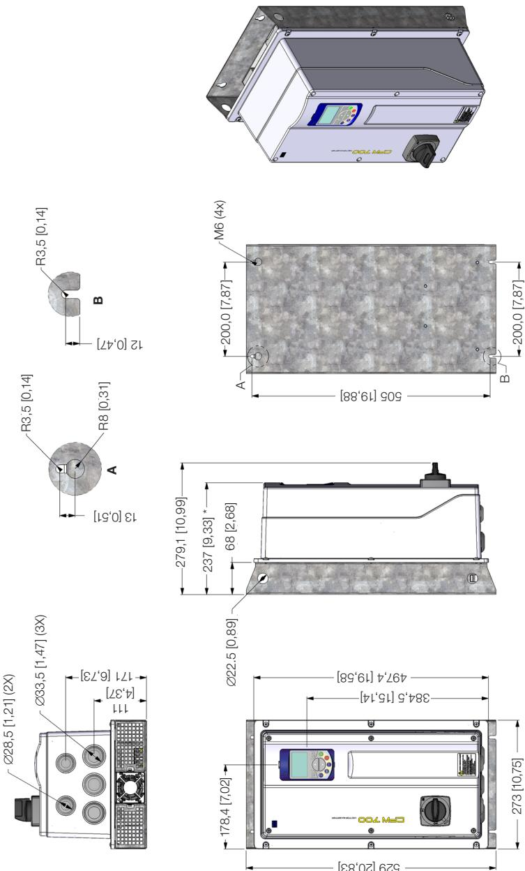
Anzahl B.6: Wechselrichterdimensionen in mm [in] - rahmengröße B mit schutzgrad IP54
