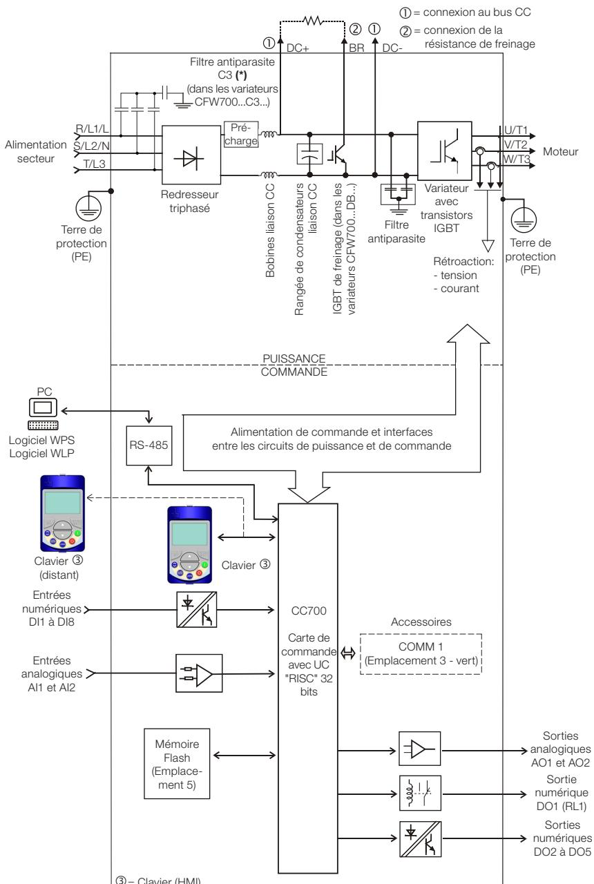
Figure 2.1 : Schéma fonctionnel du variateur CFW700
