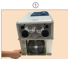
**Verwijderen van de schroeven van het ventilatorrooster**
