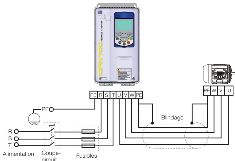
Le sectionneur n'est pas nécessaire si le variateur a l'élément DS en option (avec sectionneur).
