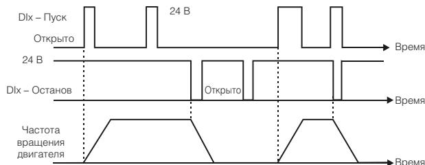
**Рис. A.7: Принцип работы приложения трехпроводного пуска/останова**
