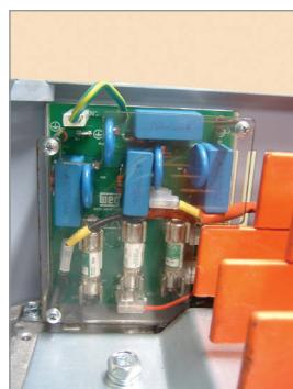
Vorgehensweise zur Trennung des RFI-Filters und des MOV (geerdet) – notwendig für den Einsatz des Umrichters in IT- oder asymmetrisch geerdeten Delta-Netzen
