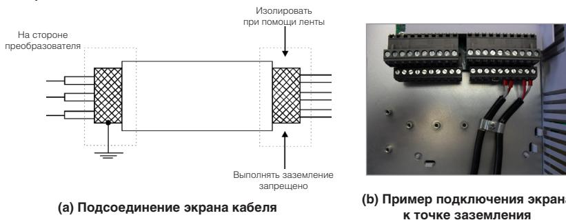
**Рис. 3.7. (a) и (b): подсоединение экрана кабеля.**
