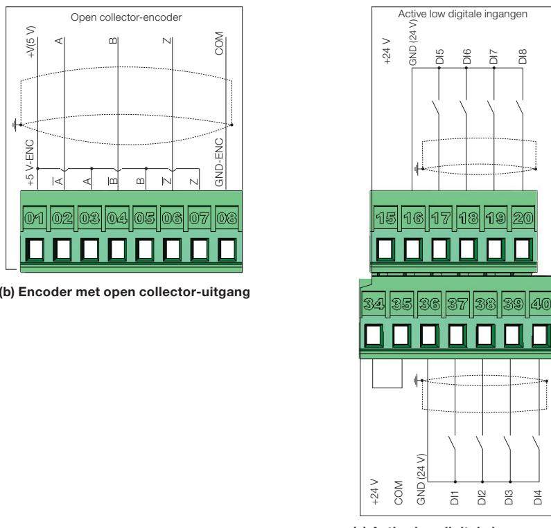
Afbeelding 3.5: (a) en (c) XC1-aansluitingen
