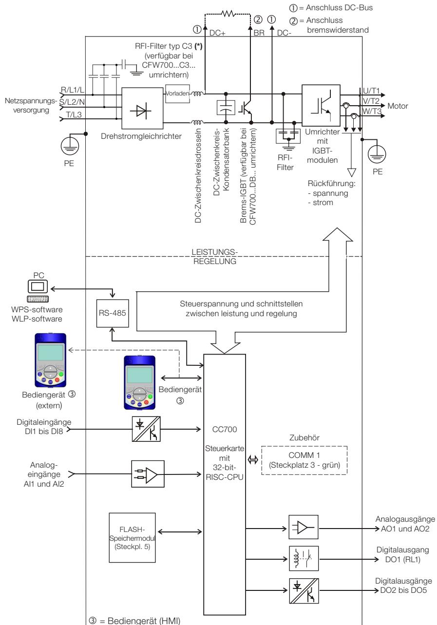
(\*) Der an den Erdungsanschluss des RFI-Filters vom Typ C3 angeschlossene Kondensator ist bei IT-Netzen und (phasengleichdeten) Dreiecksnetzen von diesem Anschluss zu trennen. (Mit diesem Filter können bei Umrichtermodellen der Baugröße A die Anforderungen der Kategorie C2 erfüllt werden.) Nähere Hinweise finden Sie in Kapitel 3.2.3.1 Eingangsanschlüsse.
