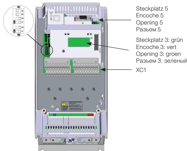
**Abb. A.3:** Positionen von Reglerkarte, XC1-Klemme (Steuersignale) und S1- (Auswahl des Signaltyps der analogen Ein- und Ausgängen) und S2- (RS-485-Modul) DIP-Schaltern
