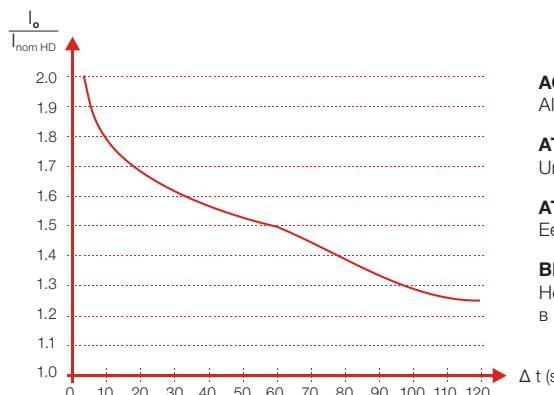
(b) IGBT-Überlastkurve für Hochlastbetrieb (HD)
