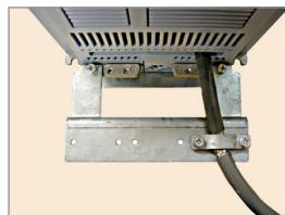
**Рис. 3.4.** Подключение экрана силового кабеля двигателя с использованием комплекта дополнительного оборудования PCSx-01
