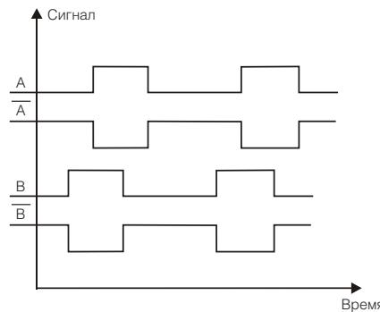
**Рис. 3.6.** Форма сигнала импульсного датчика частоты вращения
