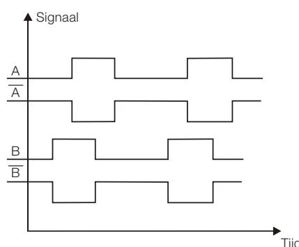
Afbeelding 3.6: Sequentie van de encodersignalen
