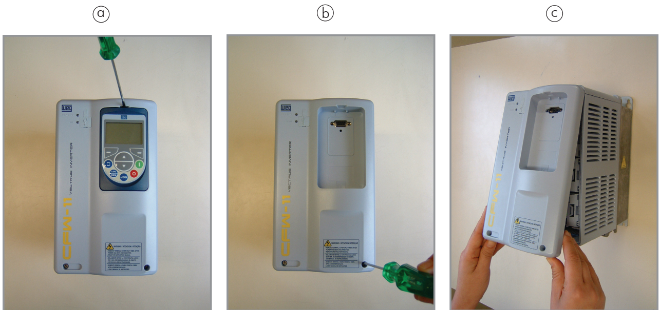
Figure 2: Démontage du couvercle frontal
