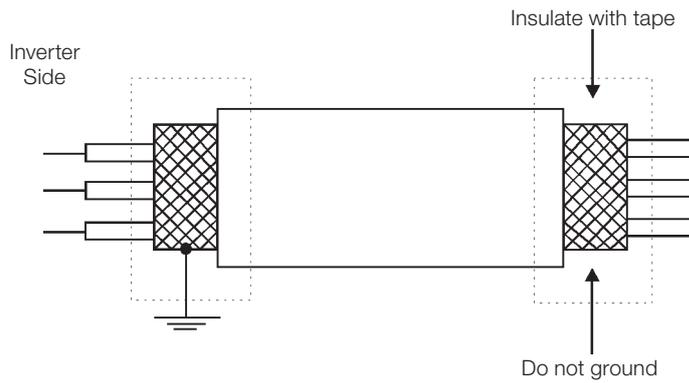
**Figure 3.42:** Conexão da blindagem
