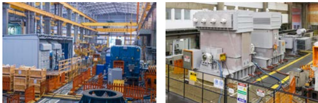
WEG实验室 - 在我们的测试设施内进行负载测试
