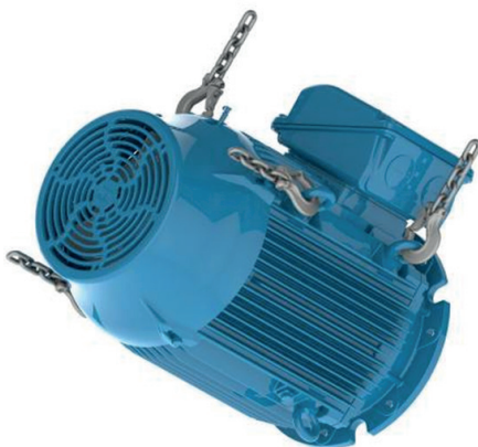
Figura 4.21: Motor está sendo girado para a posição horizontal
