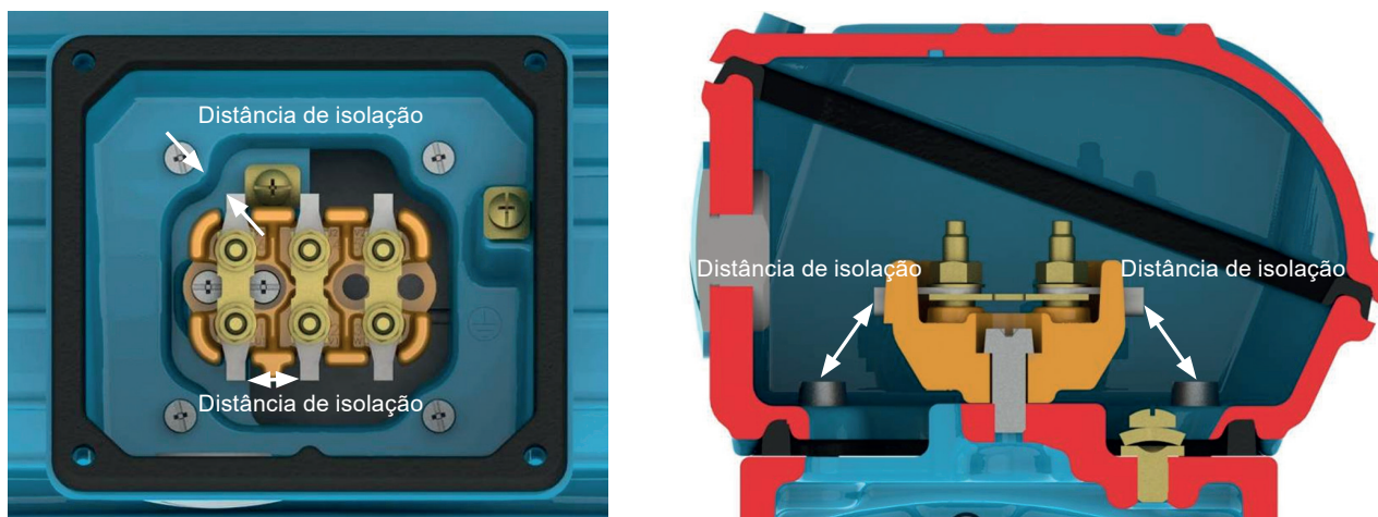
Figura 6.16: Representação da distância de isolamento
