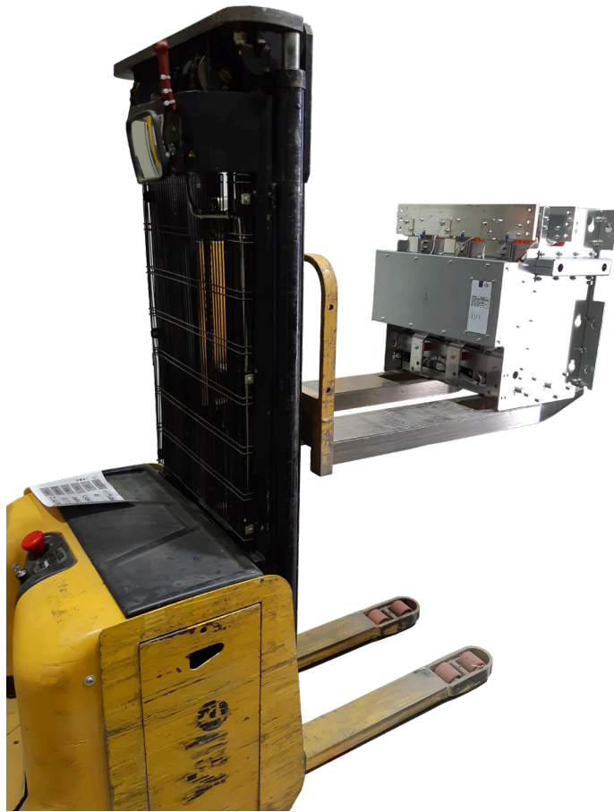
Figura 3.5: Elevação da UR11 G2 utilizando-se uma empilhadeira
