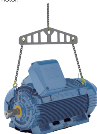
Figura 7 - Izamiento con cadenas inclinadas.
