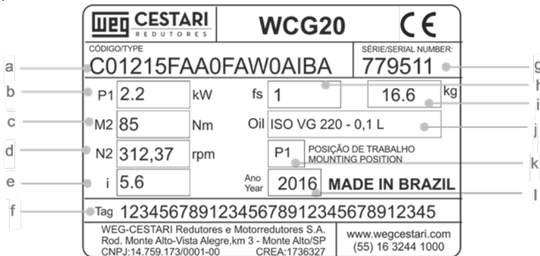
Figura 1 - Placa de identificación WCG20 (ejemplo)
