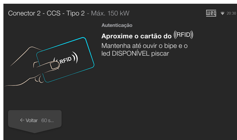
Figura 7.8: Tela com instruções para liberação da recarga via RFID
