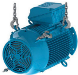
Afbeelding 14 - Installatie van het tweede paar oogbouten
