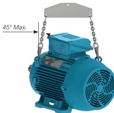
Afbeelding 7 - Maximale resulterende hoek voor motoren met twee of meer hijs oogbouten
