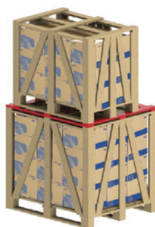
Afbeelding 28 - Gebruik van extra latten voor het stapelen
