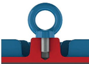
Afbeelding 4 - Correct aenraaien van de oogbout
