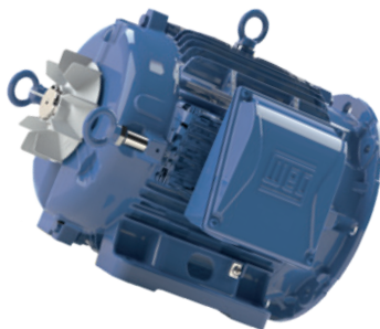
Afbeelding 17 - Oogbouten met verlengstuk bevestigd aan de BDE-zijde om de motor in verticale positie te plaatsen, met het uiteinde van de as naar beneden gericht (V5/V35)
