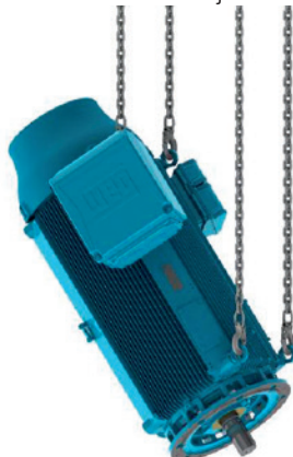
Afbeelding 19 - HGF-, W50- en W51 HD-motoren in verticale positie plaatsen
