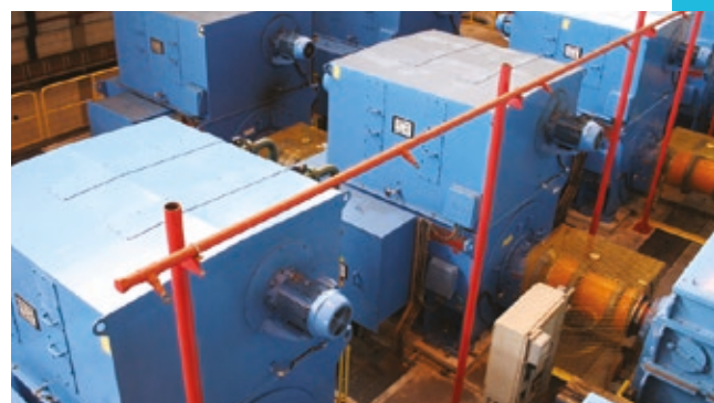
Motores Síncronos SDL800, 3.000 kW, 3.100 V Aplicação: Laminadores (siderurgia)
