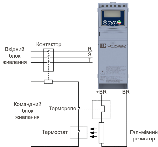
Рисунок 3.2: Встановлення гальмівного резистора
