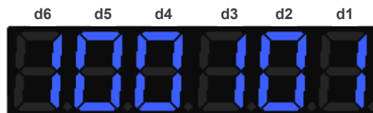
Figura 8.1: Exemplo do display mostrando Estado das DIs
