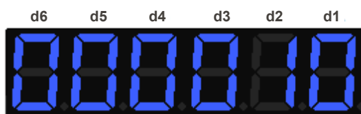
Figura 8.5: Exemplo do display mostrando Estado das DOs
