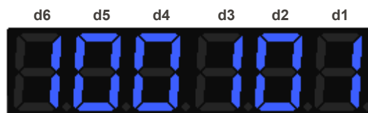
Figura 8.4: Exemplo do display mostrando Estado das DOs
