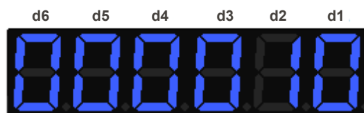
Figura 8.2: Exemplo do display mostrando Estado das DIs
