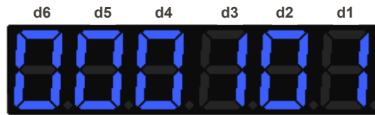
Figura 8.3: Exemplo do display mostrando Estado das DOs
