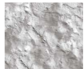
CSP 10 – Martetele de concreto de mano seguido de granallado abrasivo 6350 µm*
