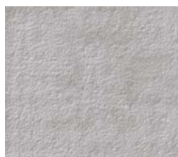
CSP 3 – Granallado leve 965,2 µm*
