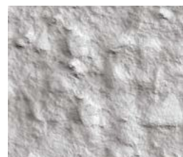
CSP 7 – Granallado pesado 4445 µm*
