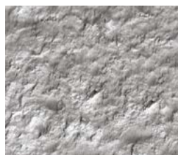
CSP 8 – Pulimiento con insertos de acero o de widia 5334 µm*
