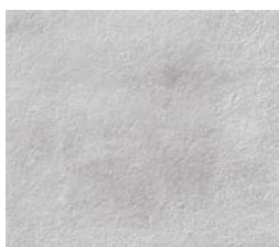
CSP 1 – Ataque ácido 685,8 µm*
