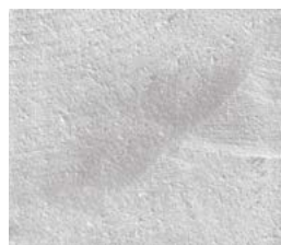
CSP 2 – Pulimiento con piedras 812,8 µm*
