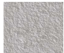
CSP 5 – Granallado medio 1676,4 µm*
