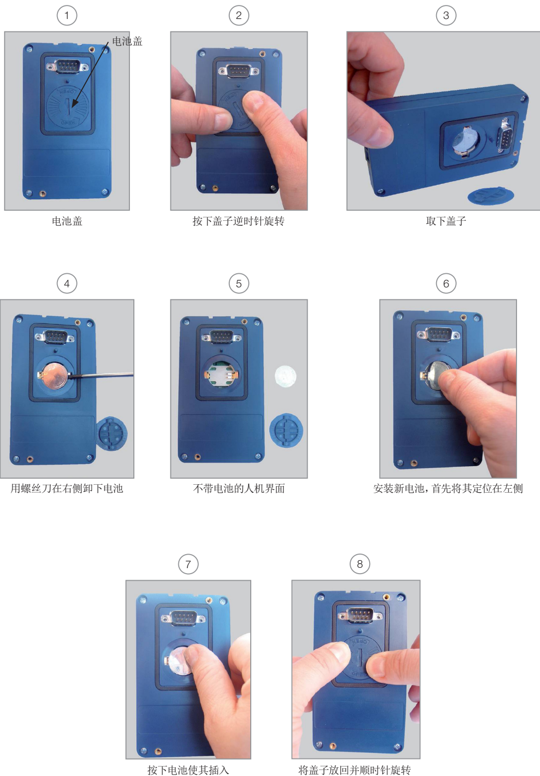
图 4.4: HMI 电池更换
