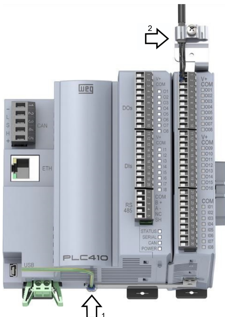
Figura 4.2: Parafusos para aterramento do produto (torque de até 0,8 Nm)
