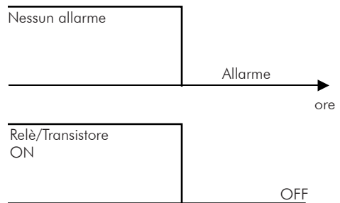
Figura 13.9 - Da (a) a (s) - Dettagli del funzionamento delle funzioni delle uscite digitali
