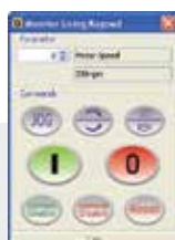
Überwachungs- und Befehlsfenster mit virt. Keyboard. Start/Stopp-Funktion, JOG, Ort-/Fernbedienung, Zurück und Zurücksetzen
