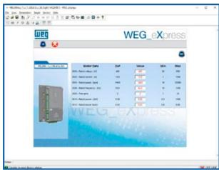
La configurazione del drive è organizzata con vari menu contestuali dove l'operatore, tramite un layout grafico, è guidato passopasso nel processo di configurazione.
