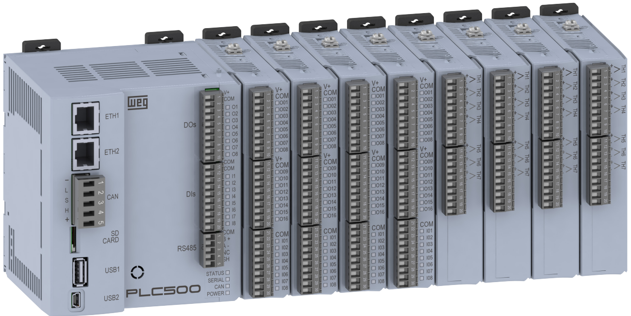
Figura 13.1: PLC500 com oito cartões de expansão
