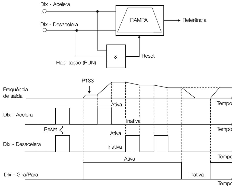
**Figura 9.13:** Exemplo da função Potenciômetro Eletrônico (E.P.)
