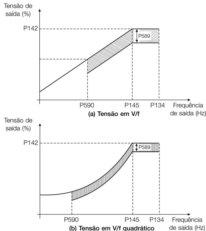
Figura 8.18: (a) e (b) Exemplo de comportamento da tensão em V/f e V/f quadrático
