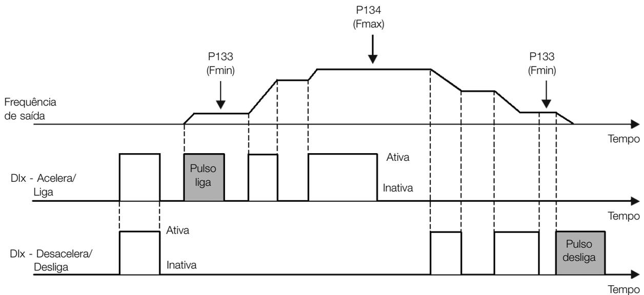
**Figura 9.15:** Exemplo da função Acelera-Liga / Desacelera-Desliga
