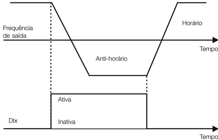
**Figura 9.11:** Exemplo da função Sentido de Giro
