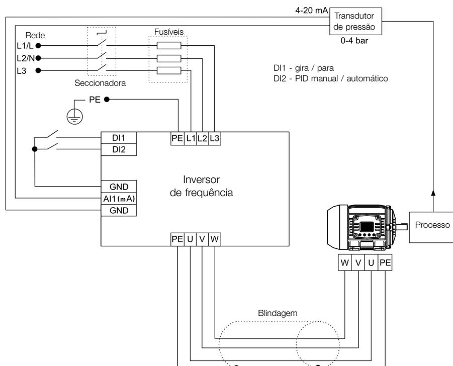
**Figura 15.7:** Exemplo de aplicação com controlador PID
