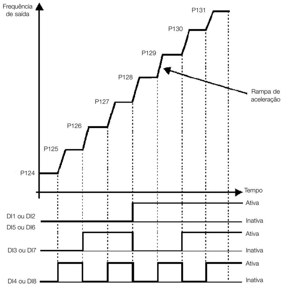
**Figura 7.3: Gráfico de funcionamento da função Multispeed**
