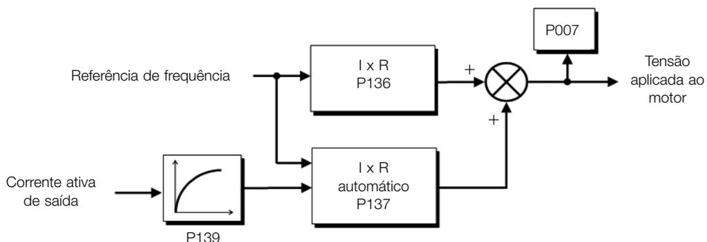
**Figura 8.16:** Blocodiagrama do boost de torque automático
