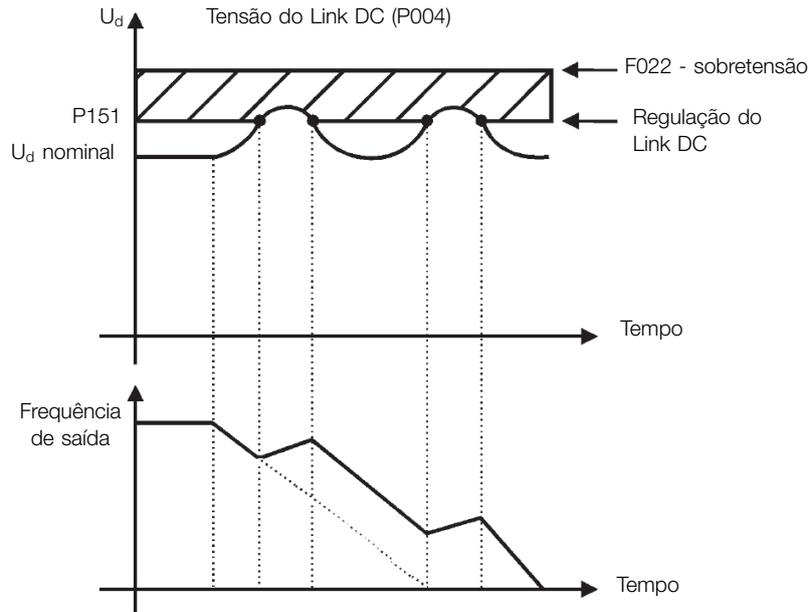
**Figura 8.5:** Gráfico exemplo da limitação da tensão do Link DC - Acelera Rampa (P150 = 0 ou 1)
