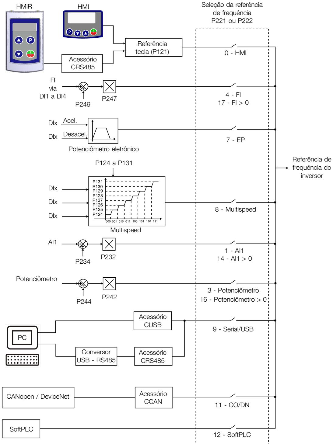
**Figura 7.2:** Estrutura de seleção da referência de frequência
