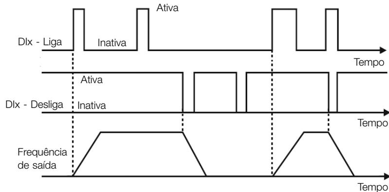
Figura 9.10: Exemplo da função Liga/Desliga
