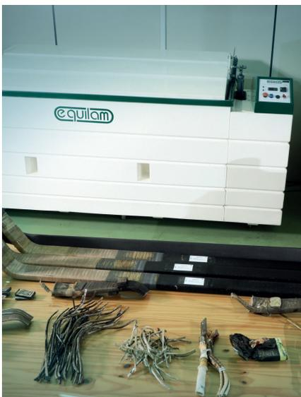
Câmara de umidade saturada
