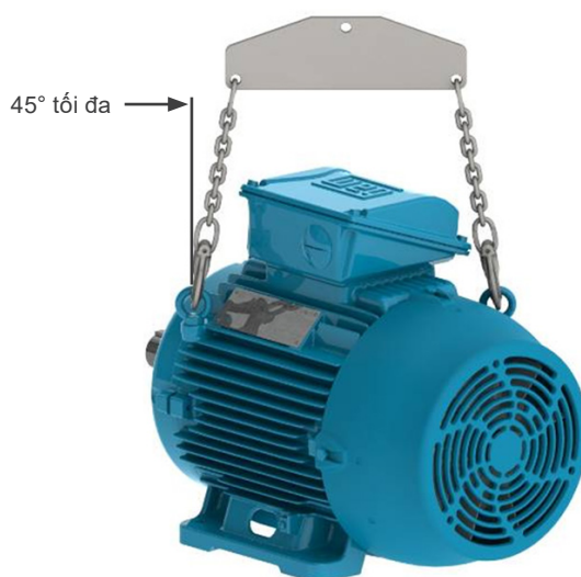
Hình 4.4: Góc kết quả tối đa cho động cơ với hai hoặc nhiều mắt nâng
