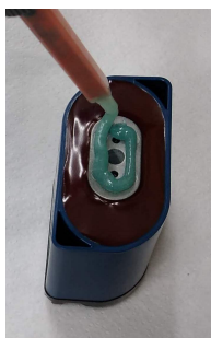
(a) Aplicação de adesivo na base do sensor
