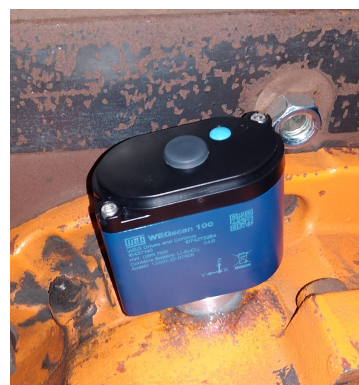
(b) Sensor instalado com suporte intermediário
