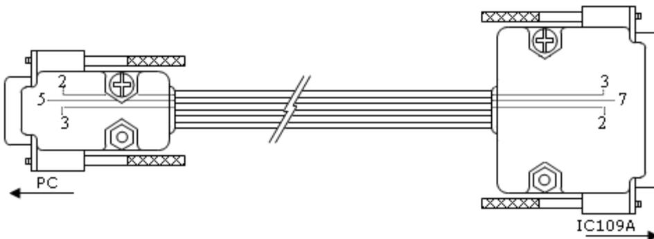
Cable plano 6 vías: solamente señal RXD, señal TXD y señal GND son utilizados.
