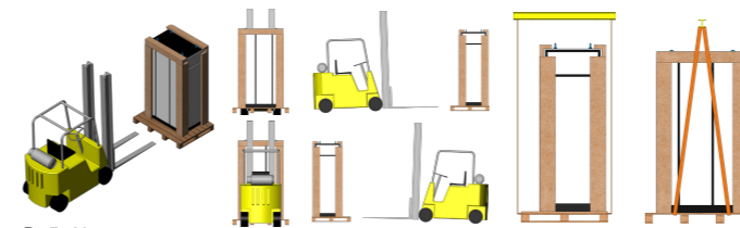
Figura 4.3: Procedimento para movimentação com empilhadeira ou talha
