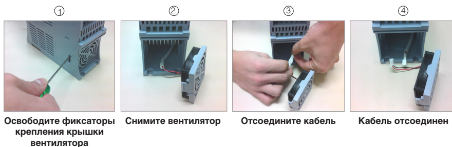
Рис. 6.1. Снятие вентилятора радиатора охлаждения
