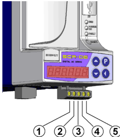
Figura 1.1: Detalhe do conector CAN na parte inferior do produto
