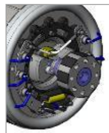
Figure 14.36 : Rotor du PMG installé
