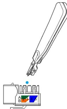
**PASSO 2:** Verifique se os cabos foram inseridos até o final. Verifique também se os cabos foram cortados para que a ponta não atrapalhe a inserção da tampa.
