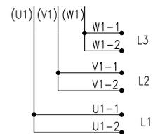
Figura 4.8: Conexões paralelas
