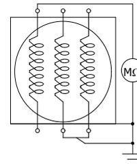
Figura 4.5: Conexão do megôhmetro em fases separadas
