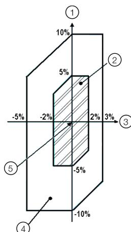
Figura 2.1: Limites das variações de tensão e frequência
