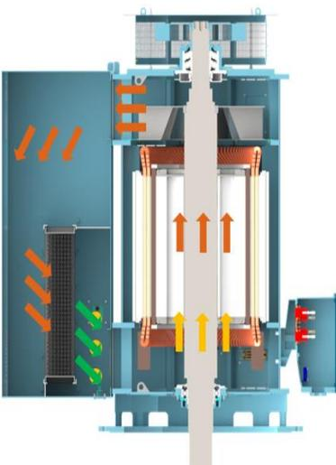
IC81W – Máquina fechada com trocador de calor ar-água autoventilada
