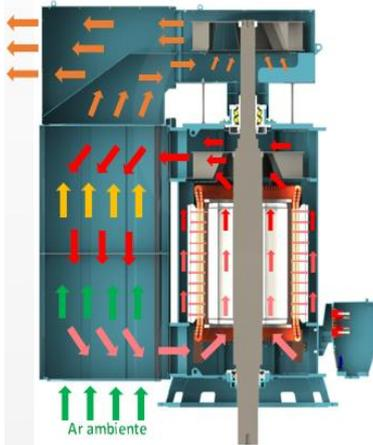
IC611 – Máquina com trocador de calor ar-ar autoventilado
