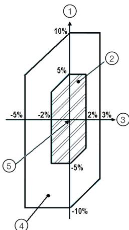
Figura 2.1: Limites das variações de tensão e frequência
