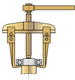
Figura 7.7: Dispositivo para sacar o rolamento
