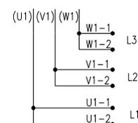
Figura 4.9: Conexões paralelas
