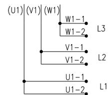
Figura 4.8: Conexões paralelas
