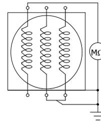
Figura 4.5: Conexão do megôhmetro em fases separadas
