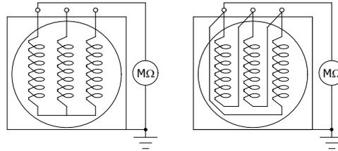
Figura 4.4: Conexão de megôhmetro
