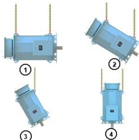
Figura 3.2: Posicionamento dos motores
