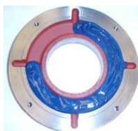
Figura 7.5: Anel de fixação externo do mancal
