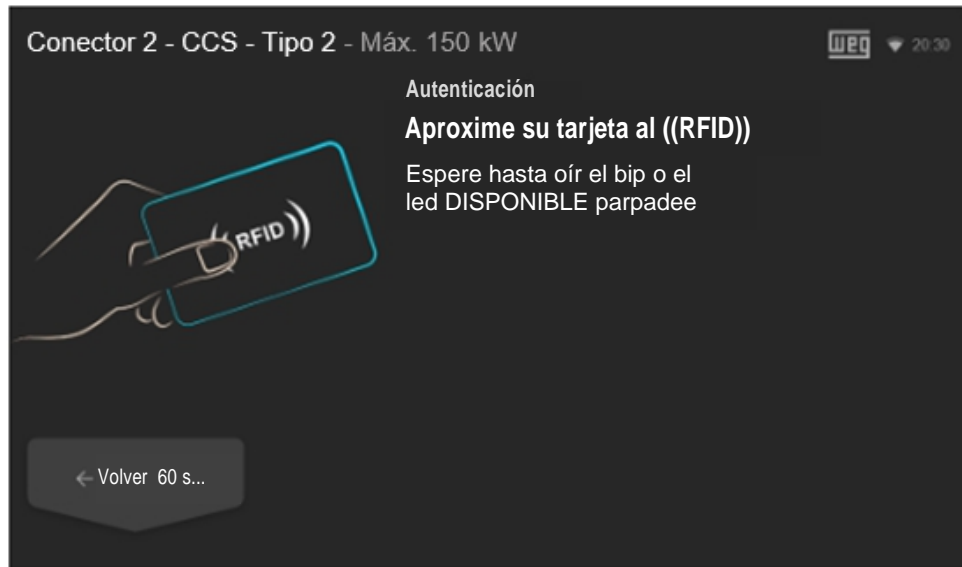
Figura 36: Pantalla con instrucciones para liberación de la recarga vía RFID
