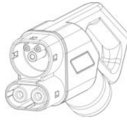
Figura 3: Modelo del conector de la WEMOB-STATION CCS-2
