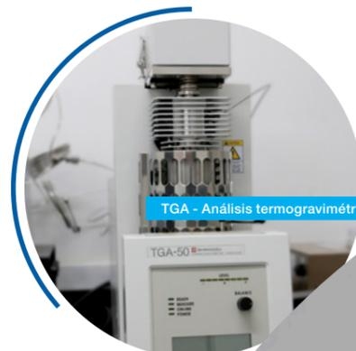
TGA - Análisis termogravimétrico
