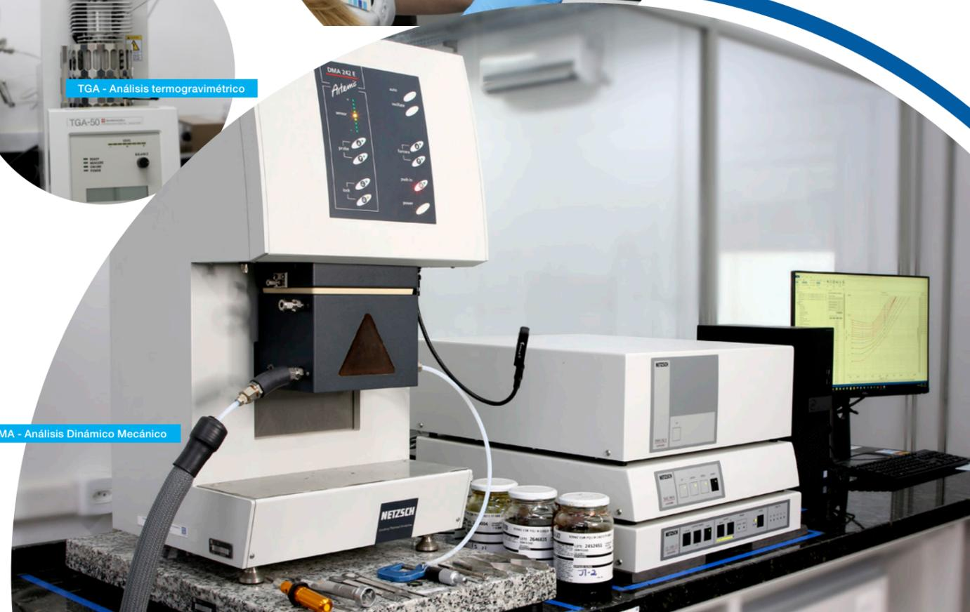
DMA - Análisis Dinámico Mecánico
