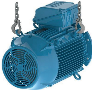
Abbildung 4.22: Endergebnis: Motor in horizontaler Position
