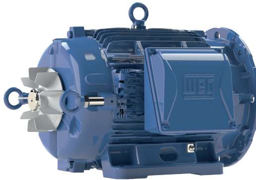
Abbildung 4.14: Ringschrauben mit Verlängerung, die an der NDE-Seite befestigt sind, um den Motor in vertikaler Position mit dem Wellenende nach unten zu platzieren (V5/V35)
