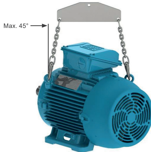
Abbildung 4.4: Maximaler resultierender Winkel für Motoren mit zwei oder mehr Hebeösen
