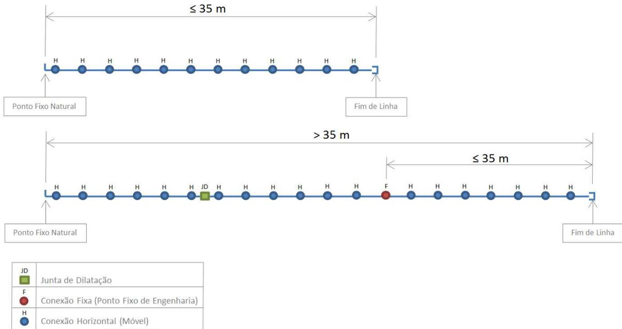
**Figura 4.57** – Localização da junta de dilatação entre ponto fixo natural e fim de linha.
