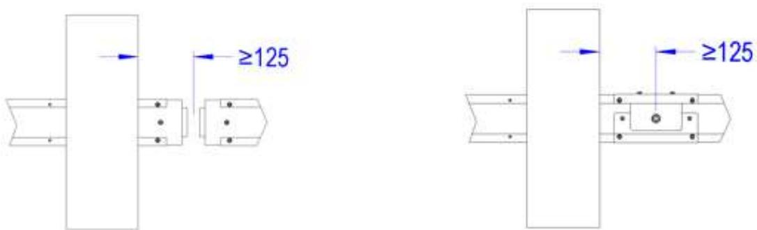
**Figura 4.18** – Distância mínima entre início do trecho e face da parede.
