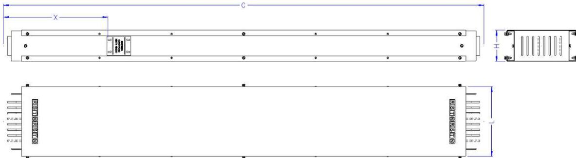
Figura 4.17 – Trechos retos horizontais (sem janela).
