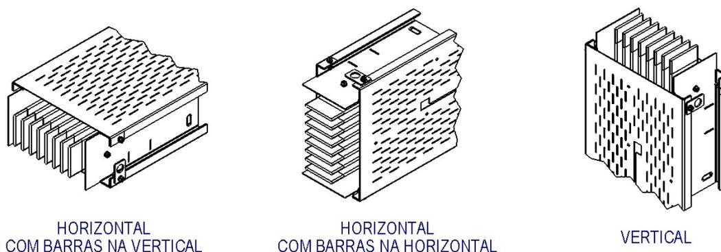
Figura 3.2 – Posições de montagem.
