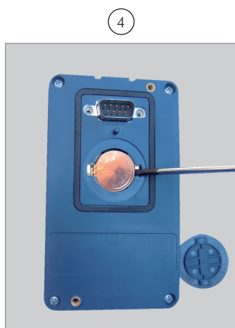
Remover a bateria com o auxílio de uma chave de fenda posicionada no canto direito
