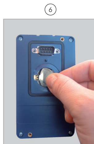
Colocar a nova bateria posicionando-a primeiro no canto esquerdo
