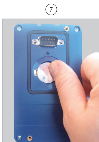
Pressionar a bateria para o encaixe
