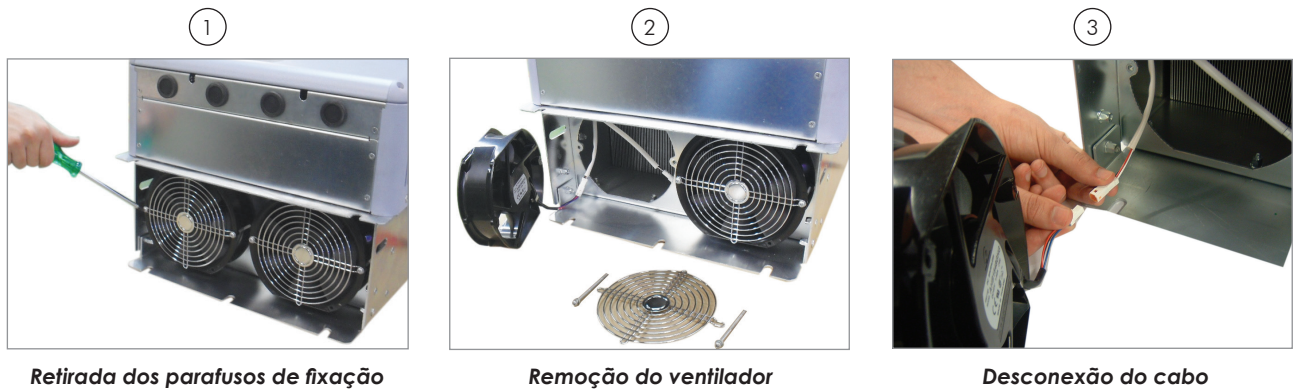
Figura 6.1 - Remoção do ventilador dos dissipadores
