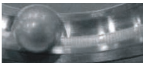
Estriamento (fluting) causado pela corrente elétrica no mancal
