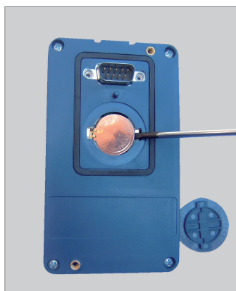
Remover a bateria com o auxílio de uma chave de fenda posicionada no canto direito
