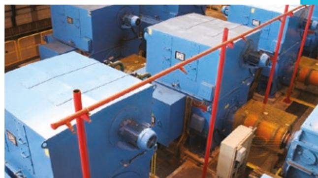
Motores sincrónicos SDL800, 3.000 kW, 3.100 V
