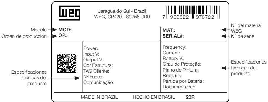
Figura 2.2: Etiqueta de identificación del UPS
