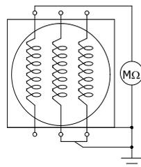
Figura 4.2: Conexão do megômetro em fases separadas
