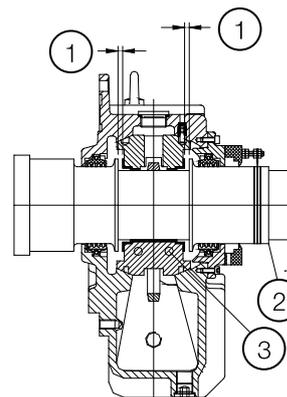
Figura 4.14: Mancal de deslizamento
