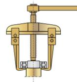
Figura 7.4: Dispositivo para sacar o rolamento
