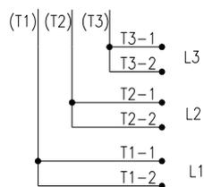
Figura 4.5: Conexões paralelas
