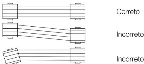
Figura 4.13: Acoplamento por polias e correias
