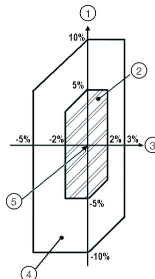
Figura 2.1: Limites das variações da tensão e frequência
