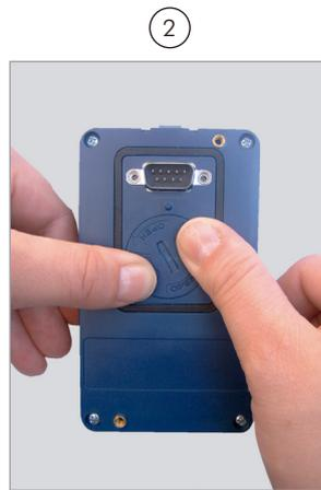
**Die Abdeckung mit dem Finger eindrücken und gegen den Uhrzeigersinn drehen**
