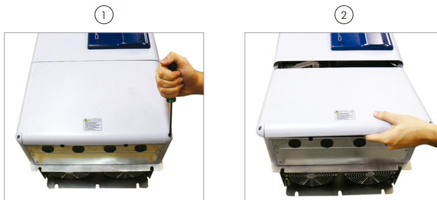
**Abbildung 3.4:** Entfernung der unteren Frontabdeckung für den Zugang zu den Spannungsversorgungs- und Motoranschlussklemmen
