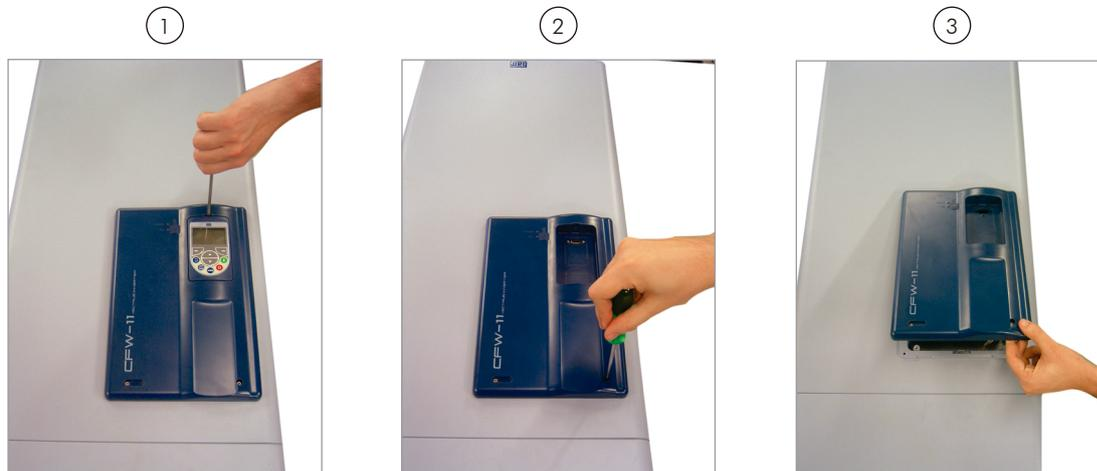
**Abbildung 3.3:** Entfernung der MMS- und Steuerungs-Rack-Abdeckung
