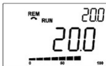
Figure 19.21: Exemple d'IHM en mode de surveillance pour la fonction du Contrôleur PID2
