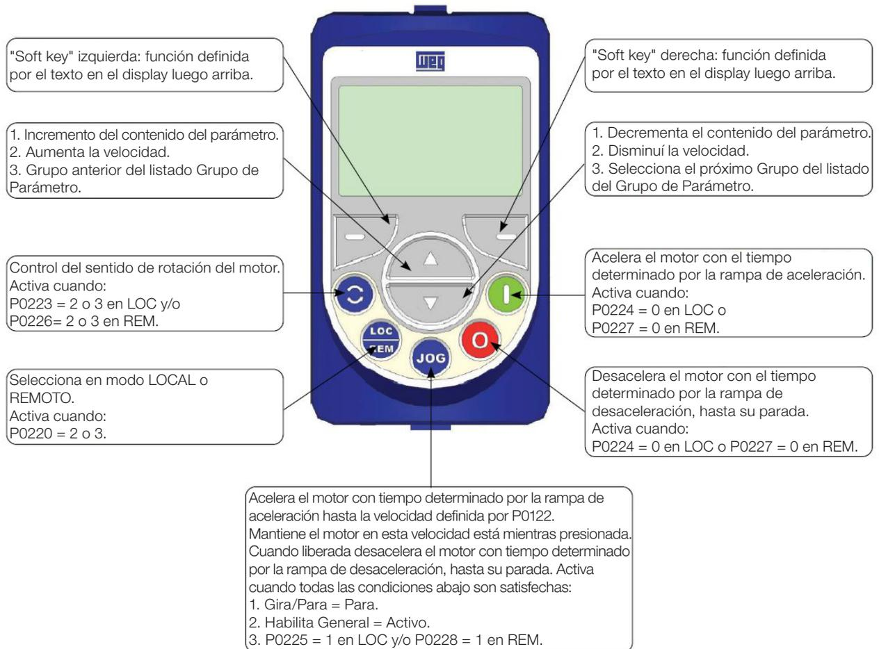
*Figura 4.3: Teclas de la HMI*
