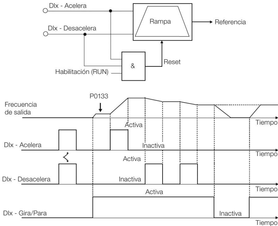
Figura 15.13: Ejemplo de la función Potenciómetro Electrónico (E.P.)
