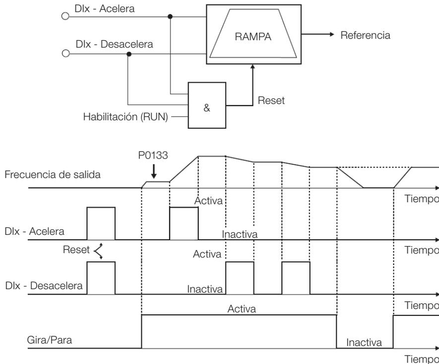
Figura 7.5: Gráfico de funcionamiento de la función E.P.
