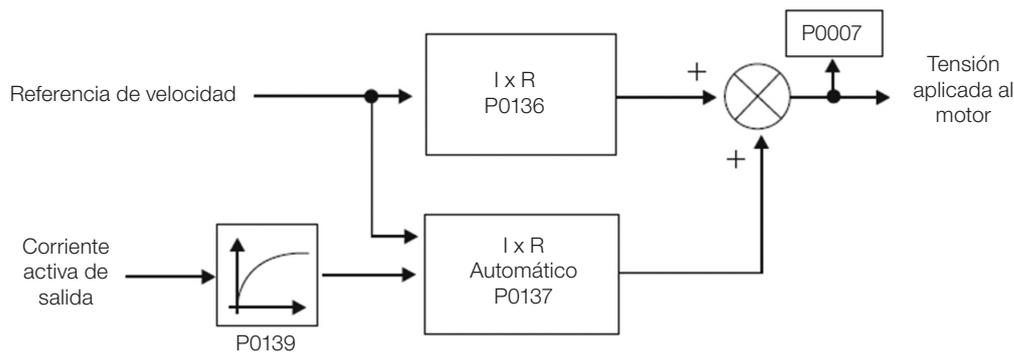
Figura 9.4: Bloque-diagrama del boost de torque automático
