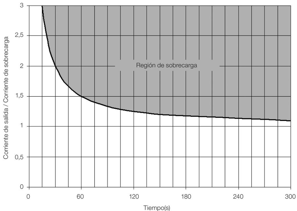
*Figura 18.1: Actuación de la sobrecarga del motor*
