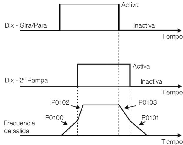
**Figura 15.14:** Ejemplo de la función 2ª Rampa
