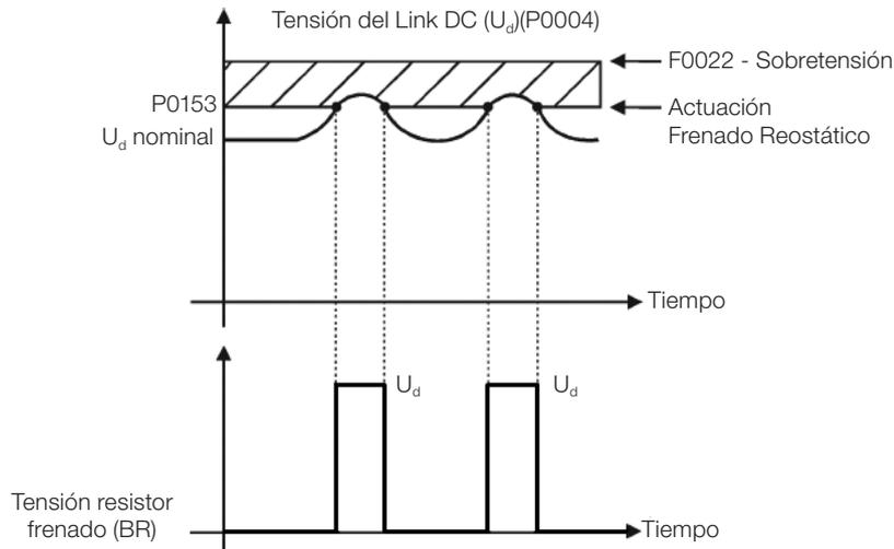
Figura 17.1: Curva de actuación del Frenado Reostático
