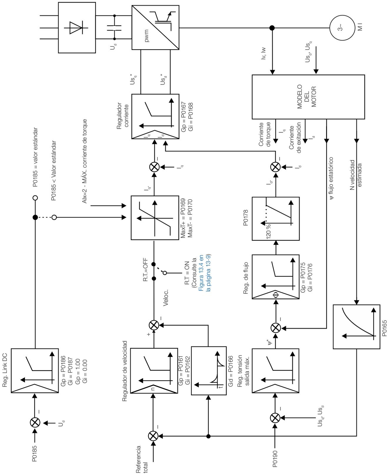
Figura 13.1: Diagrama de bloques del control vectorial sensorless
