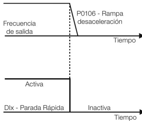
Figura 15.8: Ejemplo de la función Parada Rápida
