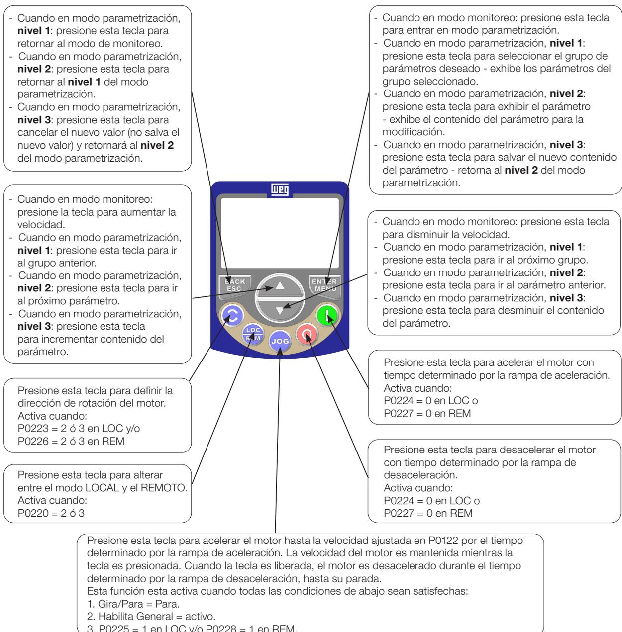
Figura 4.1: Teclas de la HMI
