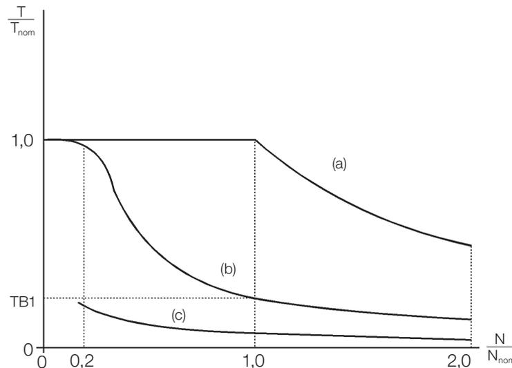
**(a) Torque (Par) generado por el motor en operación normal, accionado por el convertidor de frecuencia en "modo motor" torque (par) resistente de carga).**
