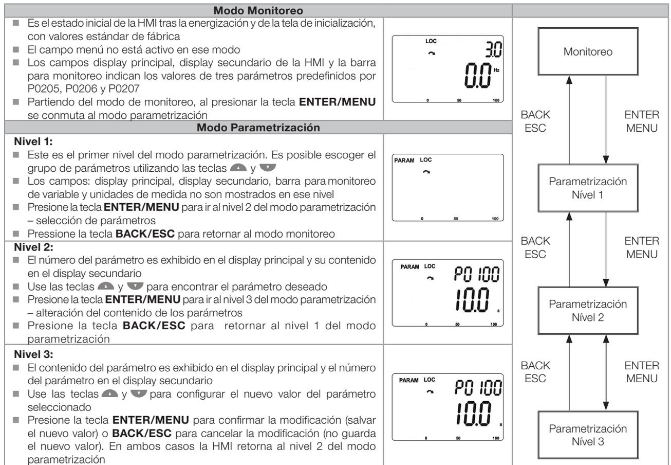
*Figura 4.5: Modos de operación de la HMI*
