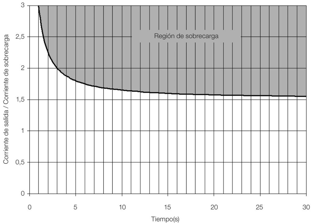
**Figura 18.2:** Actuación de la sobrecarga de los IGBTs
