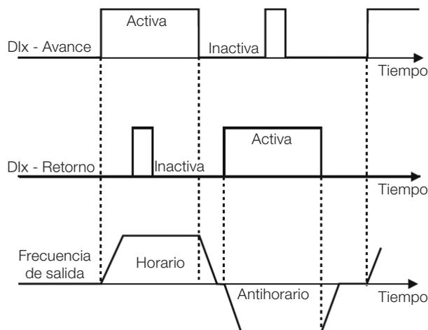
Figura 15.9: Ejemplo de la función Avance/Retorno
