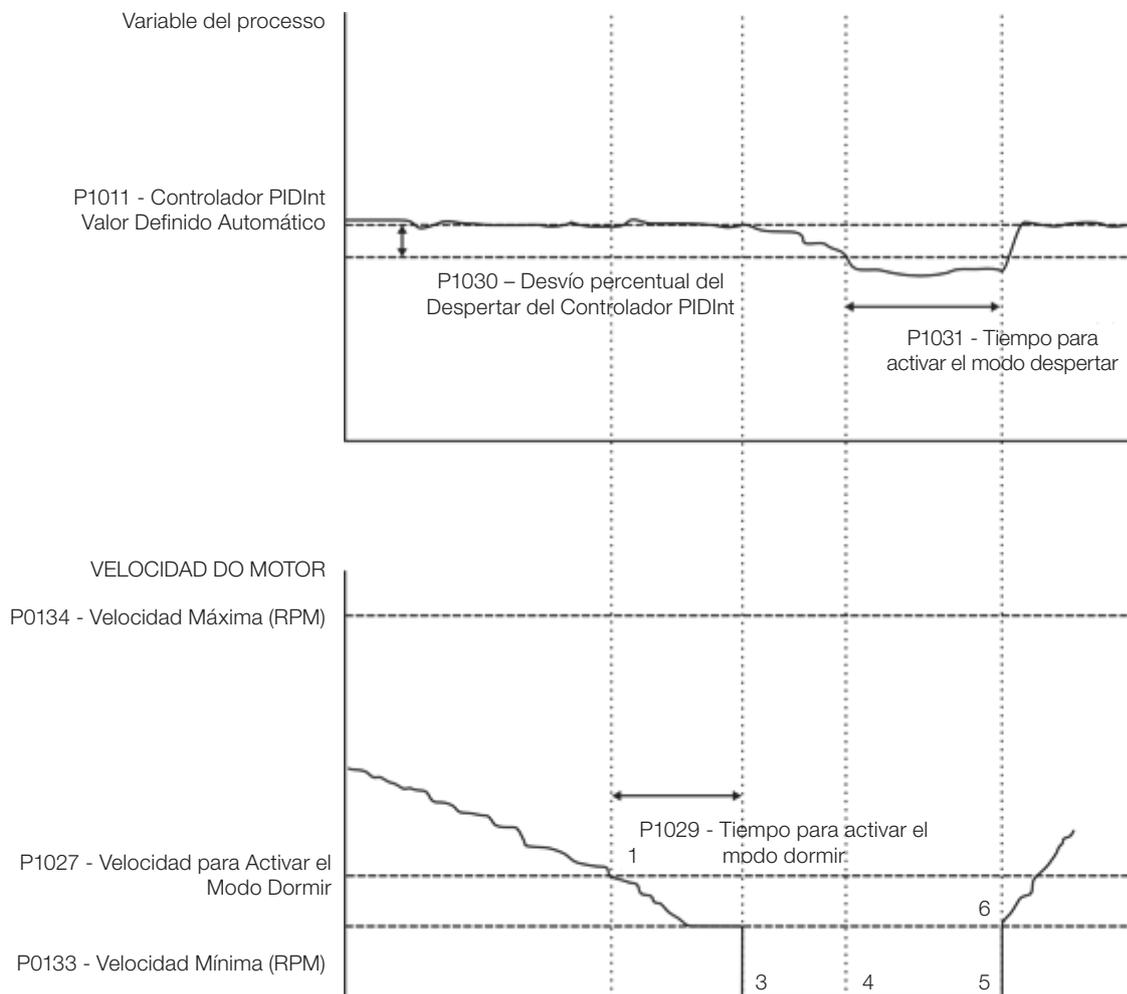
**Figura 21.1:** Esquema de funcionamiento para modo dormir y modo despertar
