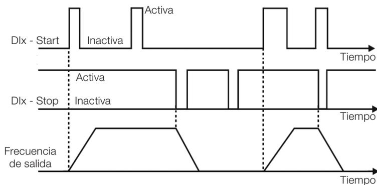
Figura 15.10: Ejemplo de la función Start/Stop tres hilos
