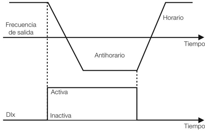
Figura 15.11: Ejemplo de la función Sentido de Giro
