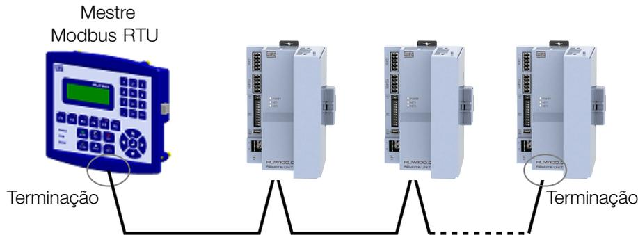
*Figura 4.1: Exemplo de instalação em rede Modbus RTU*
