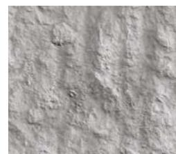
CSP 9 – Escarificación (fresa) pesada
