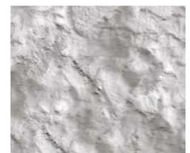
CSP 10 – Marteteo de concreto de mano seguido de granallado abrasivo
