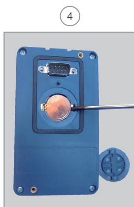
Rimuovere la batteria facendo leva con un cacciavite sul lato destro
