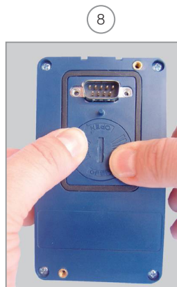
Riposizionare lo sportello e ruotare in senso orario
