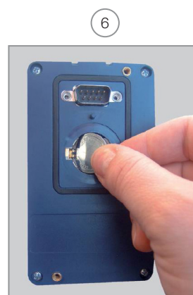
Installare la nuova batteria inserendo il lato sinistro per primo
