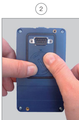
Premere lo sportello e ruotare in senso antiorario
