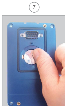
Premere la batteria per completare l'inserimento
